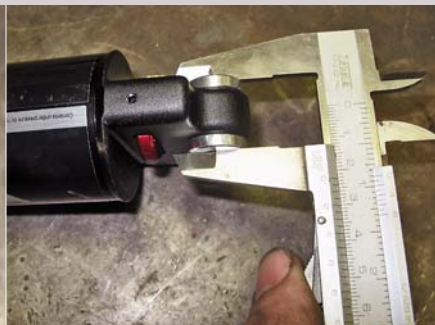
Šířka vložek musí odpovídat rozteči v rámu a samozřejmě musí být mezi osazením větší prostor, než je šířka oka tlumiče, jinak by se vložky uvnitř nezapíjely a netočily se.
