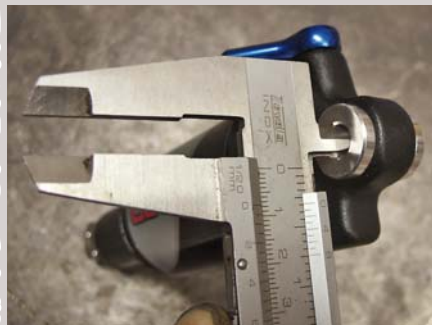
Pro správné usazení tlumiče v rámu je důležitý vnitřní i vnější průměr vložky v oku. Ujistě usazení na šroubu zamezí postupnému poškození úchytu v rámu.
