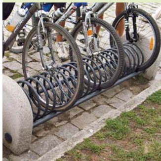
Další z variací na téma: „Jak poškodit výplet a zlomit ráfek“. Stejně tak bychom nechtěli být majiteli krajního kola, jehož vidlice se dostává do kontaktu s betonovou bočnicí.
