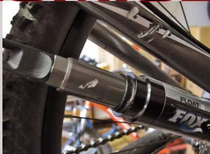
Základem pro dlouhou životnost tlumiče je čistá a nepoškozená pístnice, to platí hlavně pro vzduchové modely. Pružinové verze ji mají skrytou pod pružinou. Takovéhle poškození znamená postupné zničení těsnících kroužků.
