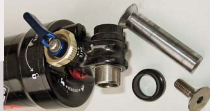
Šířka vložek musí odpovídat rozteči v rámu a samozřejmě musí být mezi osazením větší prostor, než je šířka oka tlumiče, jinak by se vložky uvnitř nezapíjely a netočily se.
